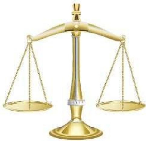
Figura Balanza de platillos, mide la masa comparándola con la de otros cuerpos de masa conocida.
